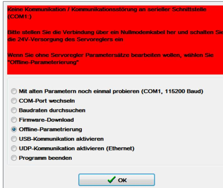
Abbildung 8-5: Offline Parametrierung
