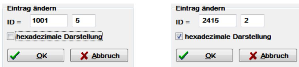
Abbildung 6-3: Eingabe einer PNU (links) oder eines CAN-Objektes (rechts)
